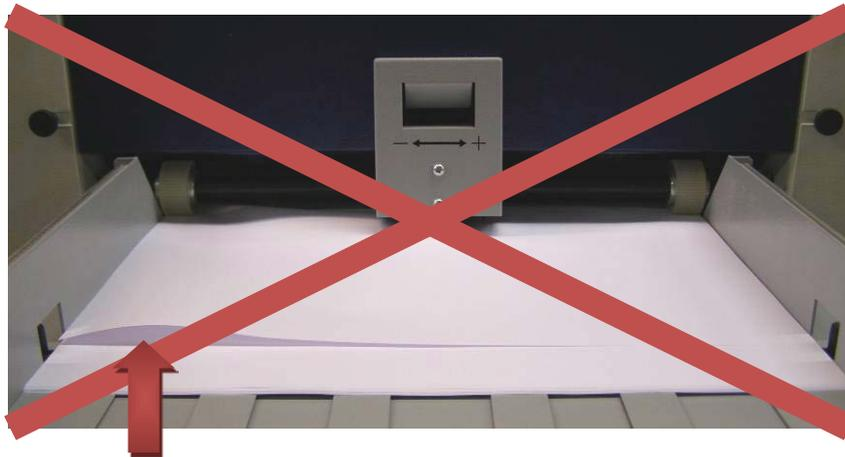
**Fig. 16:** Ejemplo de una pila de papel mal colocada – demasiada presión para papel de bajo gramaje.
