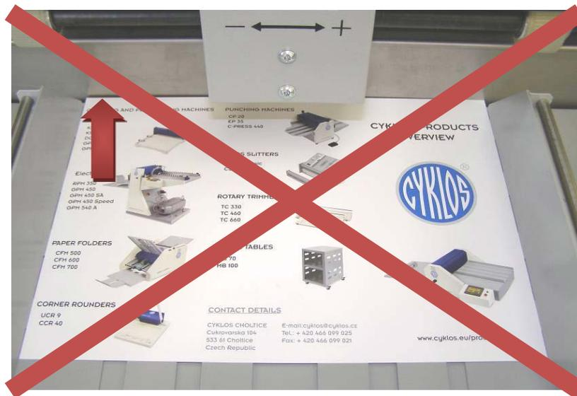
**Fig. 10:** Bandeja mal preparada – el papel no está apoyado en toda su longitud sobre la placa de acero inoxidable
