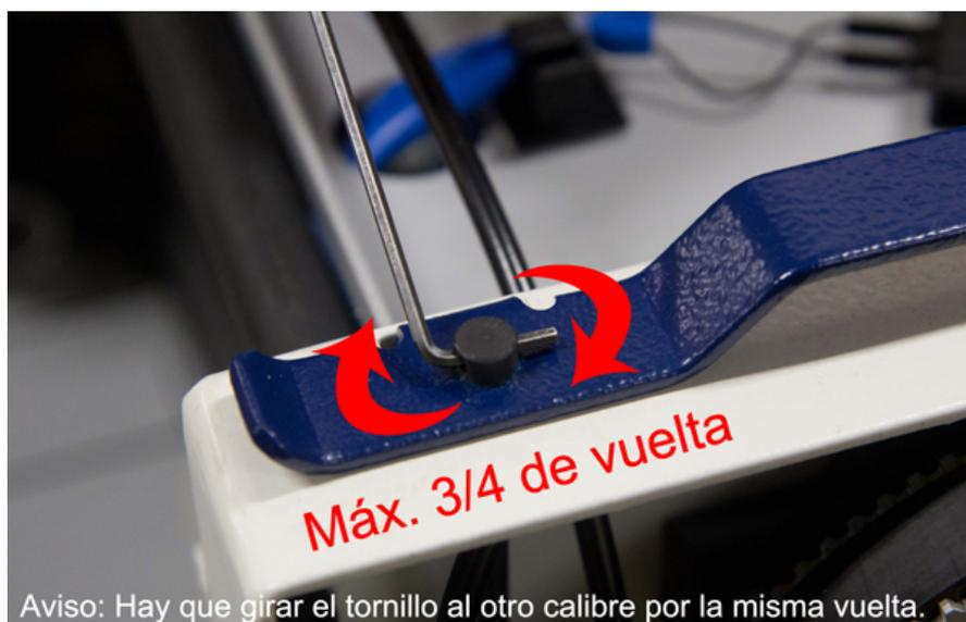
**Fig. 34:** Al girar el tornillo de calibre el eje de los rodillos de alimentación se mueve hacia abajo, reduciendo la brecha entre el rodillos de alimentación y el separador.
