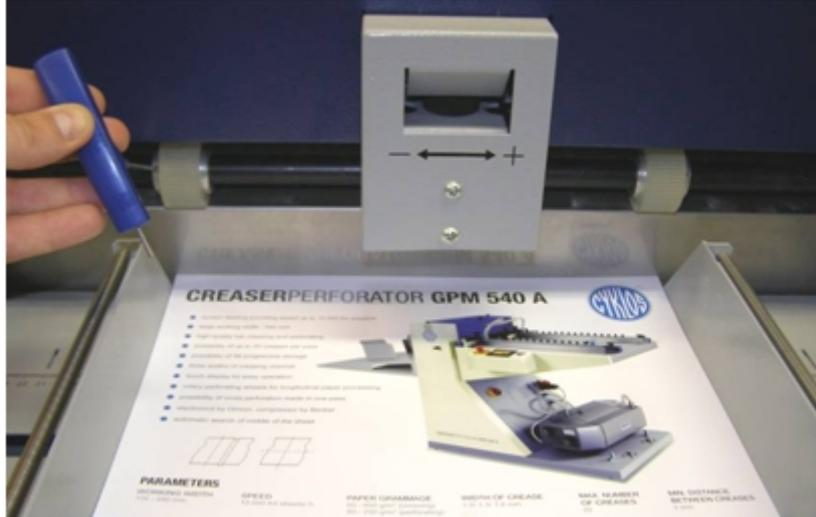
**Fig. 11:** Ajuste de la rueda de alimentación (posición 29) con una llave allen T
