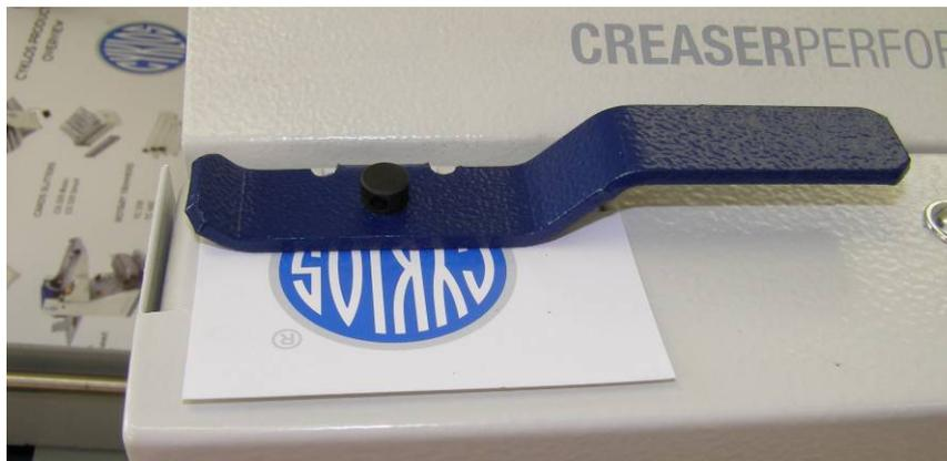
**Fig. 18:** Definir el espacio del sistema de alimentación de fricción al colocar el papel debajo del calibre
