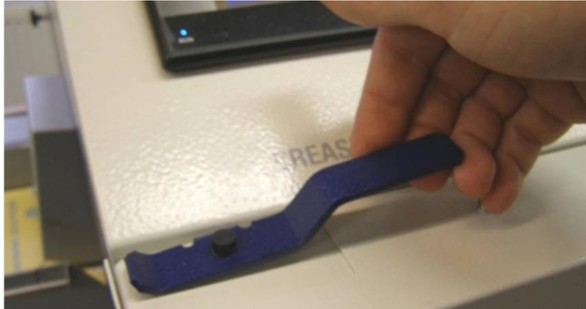
**Fig. 17:** Tirar el calibre a la posición superior
