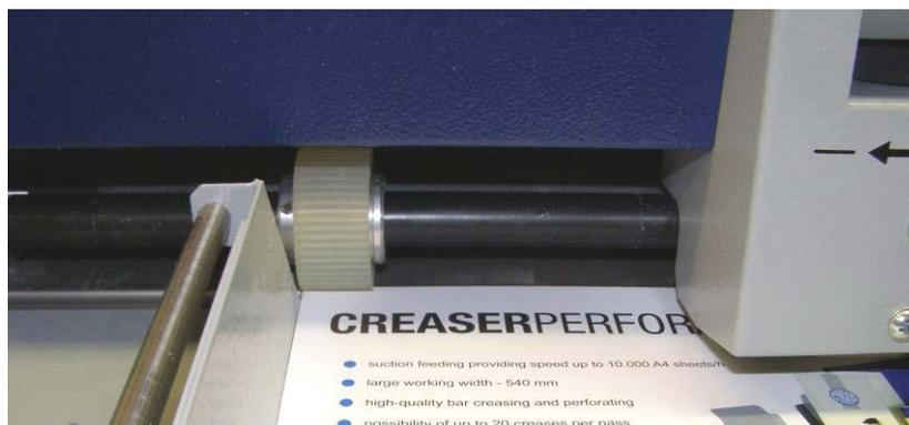
**Fig. 12:** Rueda de alimentación correctamente ajustada
