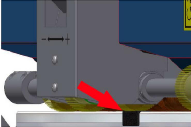
**Fig. 35:** La brecha entre el separador y el rodillo de alimentación debe ser de entre 0,05 y 0,1 mm.
