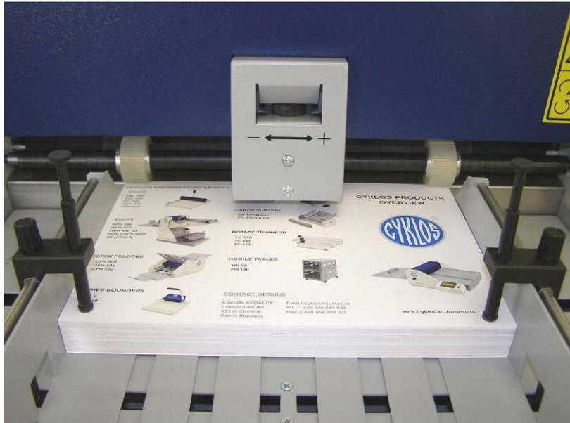
**Fig. 15:** Ejemplo de una pila de papel correctamente colocada
