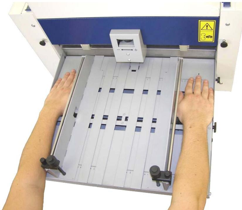
**Fig. 6:** Presionar la bandeja antes de colocar el papel.
