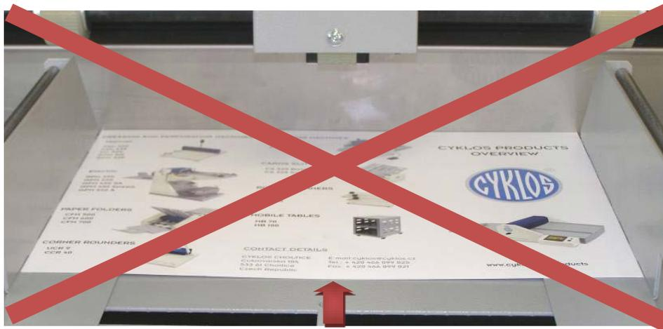
**Fig. 8:** Bandeja mal preparada – la falta de las cintas de separación magnéticas (posición 5) resultan en la deformación del papel.
