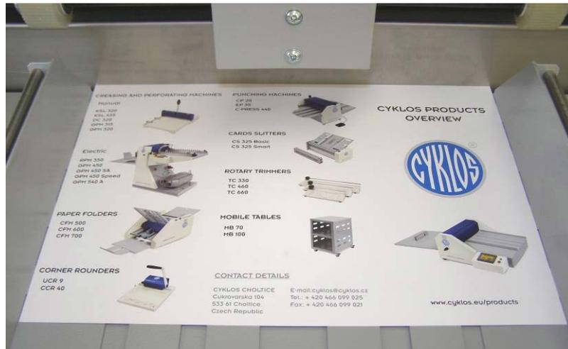
**Fig. 9:** Bandeja preparada correctamente – el papel está apoyado sobre la placa de acero inoxidable
